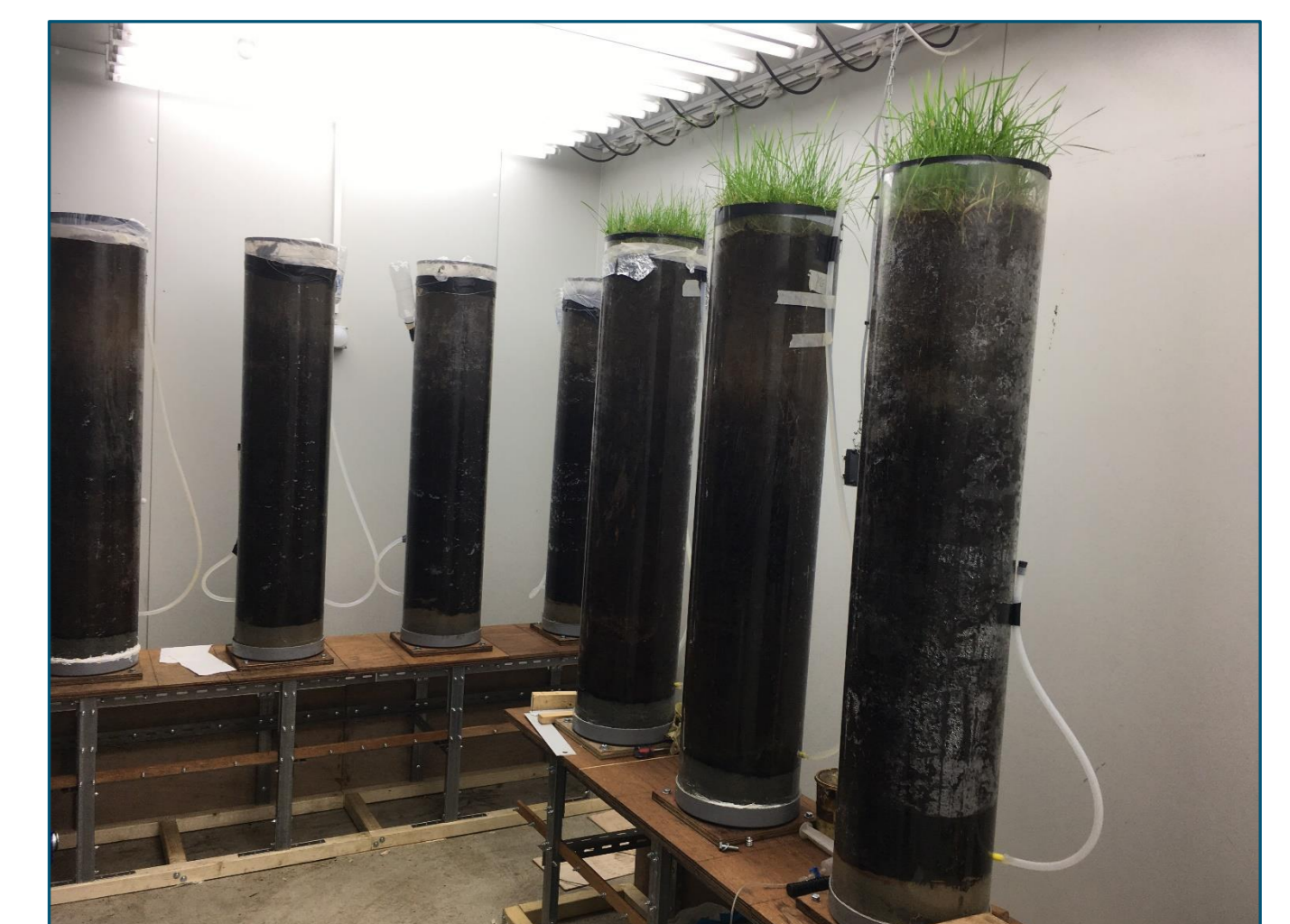
Figuur 5. Voorbereiding kolomexperiment in klimaatkamer.
